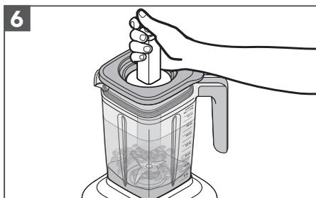
**6** **Accesorio prensador:** Quite la tapa tapa central solamente. Remueva o empuje el contenido hacia la cuchilla. A continuación, coloque la tapa central antes de reanudar la mezcla.
